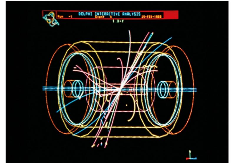
En fait: une simulation informatique d'une collision électron-positron dans le Détecteur DELPHI au CERN en 1988. DELPHI était l'un des quatre détecteurs du prédécesseur du LHC, le grand collisionneur électron-positon LEP. Les lignes horizontales bleues représentent les faisceaux de particules qui se percutent dans la cavité cylindrique du détecteur. De ce fracas naissent de nouvelles particules dont les traces (en arc) s'étendent depuis la piste du milieu vers l'extérieur.
